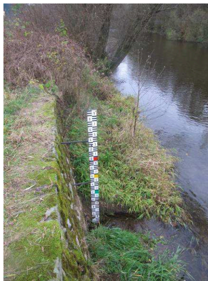
Obr. č. 17 Vodočet pro dílčí část hladiny Obr. č. 18 Vodočet pro celý rozsah hladiny
