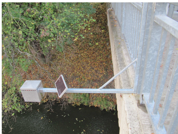
Obr. č. 14 Radiační kryt sondy Microflex
